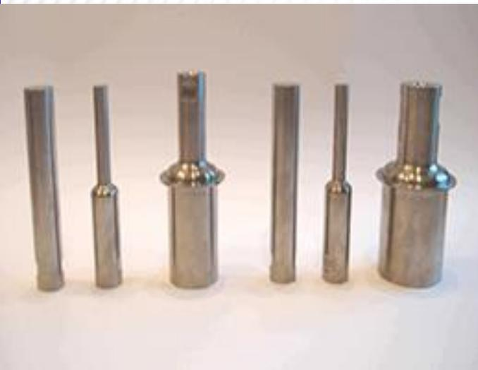
*Наноструктура* в крупногабаритных заготовках титановых сплавов получена путем механотермической обработки с использованием методов интенсивной пластической деформации.
