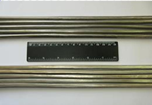
Технология позволяет получать *наноструктурное и субмикроструктурное состояние* в титане с применением широко используемого промышленного оборудования (прессы, штампы, прокатные станы и т.п.).
