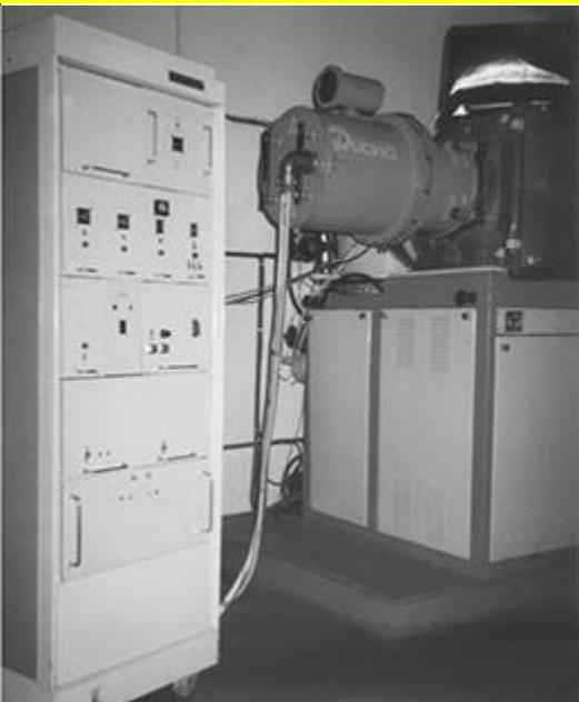
*Нанотехнология и установка* предназначены для **ионнопучкового наноструктурирования поверхностных слоев** деталей машин и механизмов, режущего инструмента, штамповой оснастки из высокопрочных конструкционных и инструментальных сталей и сплавов, сварных соединений, керамики, полимерных материалов и композитов.
